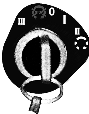
Рисунок 2.2.2 – Схема положений ключа выключателя стартера и приборов
