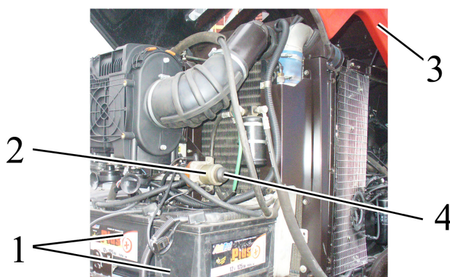
1 – аккумулятор; 2 – ручной выключатель АКБ; 3 – капот; 4 –кнопка ручного выключателя АКБ.
